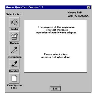
Mit dem Mwave Quick Test-Programm können Sie die einzelnen Boardfunktionen testen (Audio, Modem, Mikrofon, Telefon). Falls Probleme auftreten, lesen Sie das "Troubleshooting"-Kapitel.
